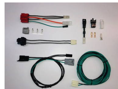
p/n 510483 84-86 Optional A/C Overlay Harness
